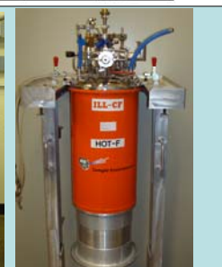
ILL LHe Cryostat Furnace Min(T)- 1.8K Max(T)- 800K
